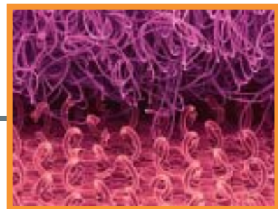
Image colorisée obtenue grâce à une micrographie électronique à balayage des deux bandes adhésives composant une fermeture VELCRO®. © Dee Breger, Drexel University
